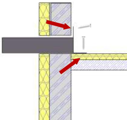
2. Prüfen Sie den Zwischenraum von Rohr und Wand. Den Ringspalt verschließen und abdichten. Achten Sie darauf keinen Druck auf das Rohr auszuüben.
