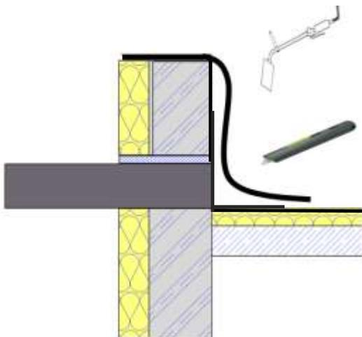
4. Oberlage aufschweißen. Achten Sie darauf, dass Sie das Bauteil nicht zu stark erhitzen. Hier kann es zu Verformungen im Material kommen. Eine einwandfreie Funktion kann dann nicht mehr gewährleistet werden. Führen Sie den Anschlussstreifen über die Rohröffnung. Achten Sie auf eine spannungsfreie Verarbeitung. Schneiden Sie die Öffnung in das Material. Der Werksflansch darf beim Freischneiden nicht beschädigt werden.
