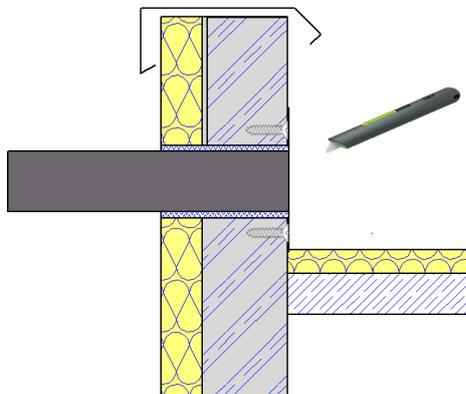
4. Öffnen Sie mit einem Messer die Eindichtung und legen die Öffnung des Rohres frei
