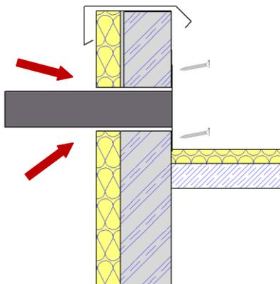
2. Prüfen Sie den Zwischenraum von Rohr und Wand und füllen sie diesen ggf. aus.
